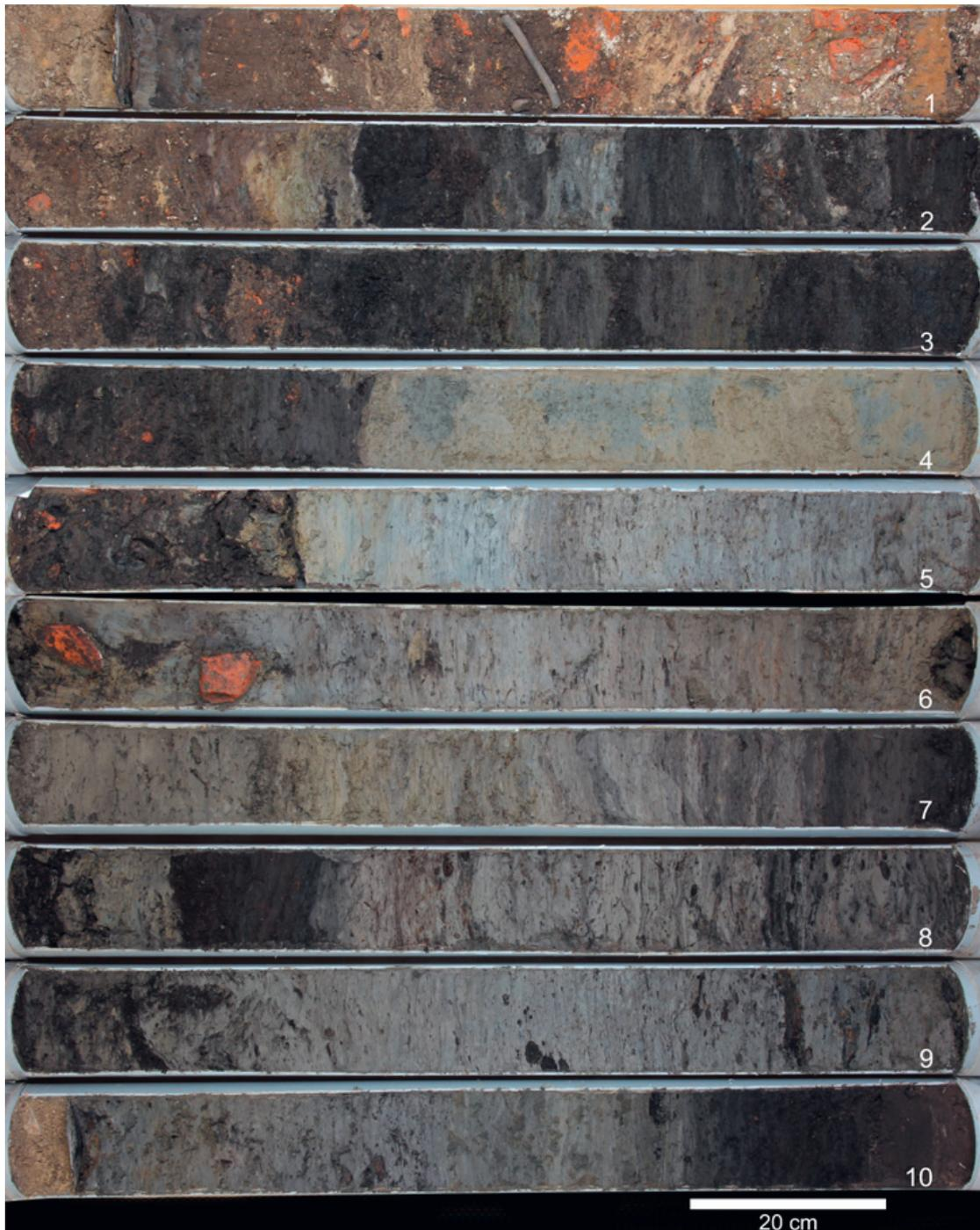
Abb. 1: Emden. Geöffnete Kerne der Bohrung Emden B01. Im oberen Abschnitt der meisten Einzelmeter ist durch die Bohrtechnik entstehender, schutthaltiger Nachfall zu erkennen. Die Wurtenaufträge sind durch hohe Organikgehalte und eine dunkle Farbe gekennzeichnet. Oberkante der Kerne jeweils links (Foto: A. Folkers, NihK).
